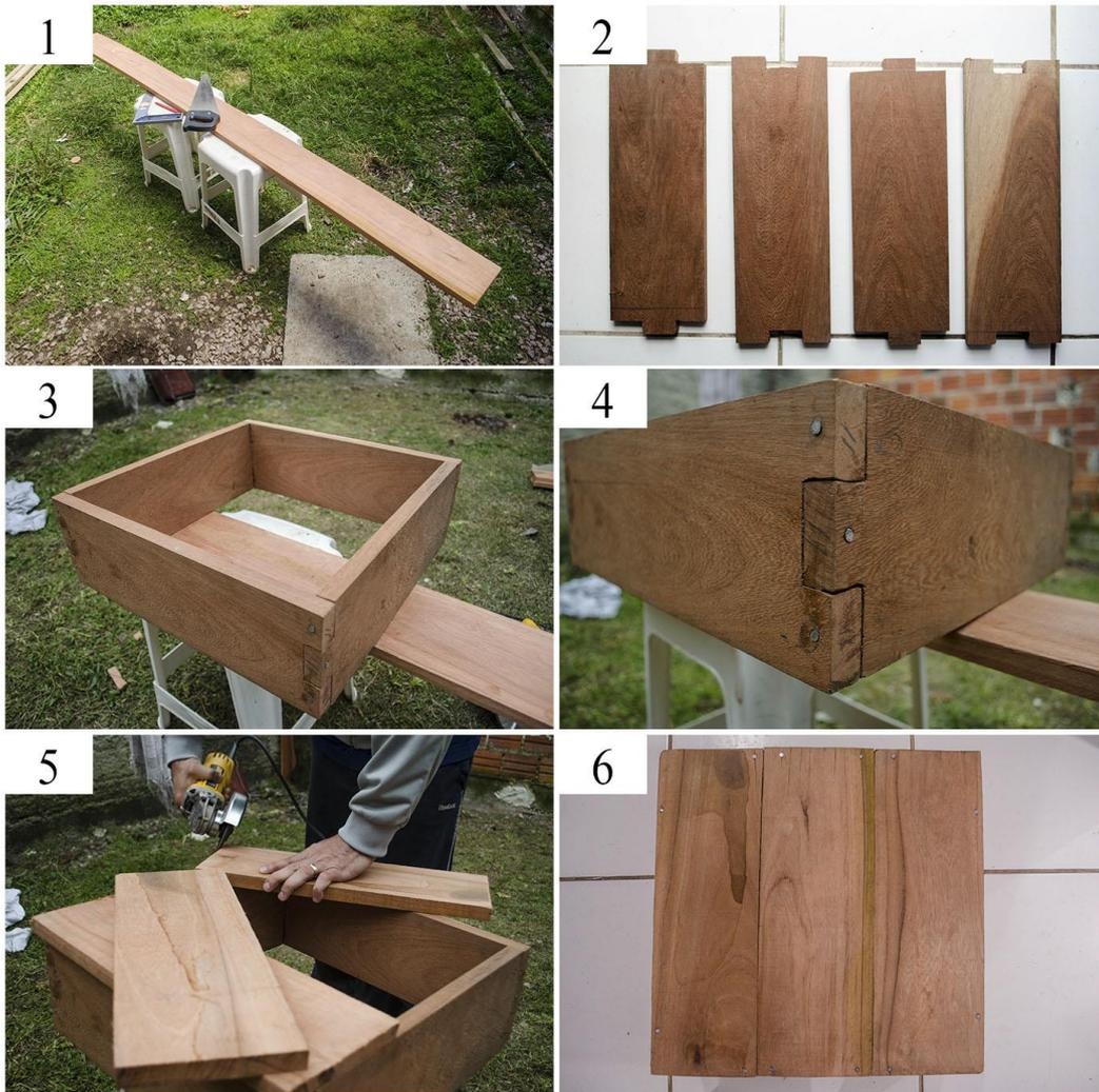
**Figura 4:** Passo a passo da construção do poço de *Foley*.
